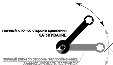
Рис. 5. Подключение к системе подачи теплоносителя
